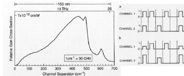
De esta forma se puede ver que la potencia umbral de SRS puede estar en el orden de varios centenares de mW, por lo que no suele afectar a sistemas de comunicaciones ópticas con una única longitud de onda. En sistemas con varias longitudes de onda puede llegar a limitar debido a mezclas de canales.
