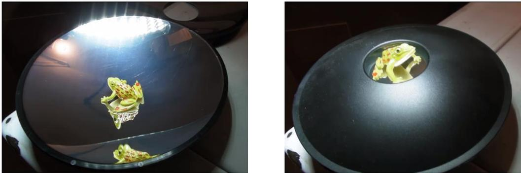
Figura 8. Ilusión óptica formada mediante el empleo de dos espejos parabólicos
