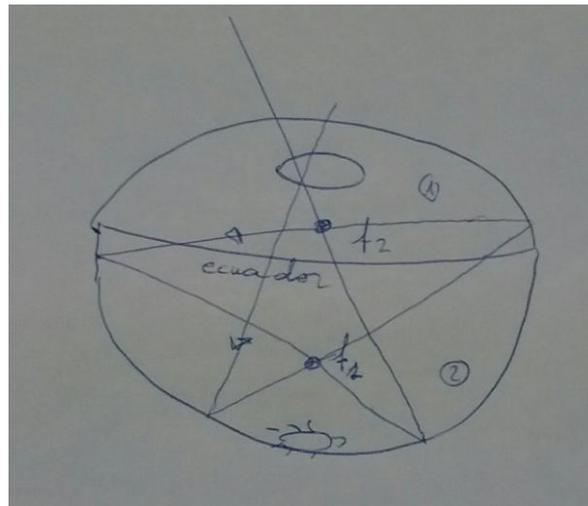
En cambio los haces que atraviesan el óculo paralelos al eje de las parábolas se reflejan en el espejo (2) hacia el foco su parábola de manera que tras pasar ese foco se reflejan en el espejo (1) que tiene como foco la posición del insecto y es ahí adónde van a caer los rayos tras el reflejo en el espejo (1). Al incidir sobre el insecto se devuelven hacia arriba formando la imagen especular del insecto en el óculo.
