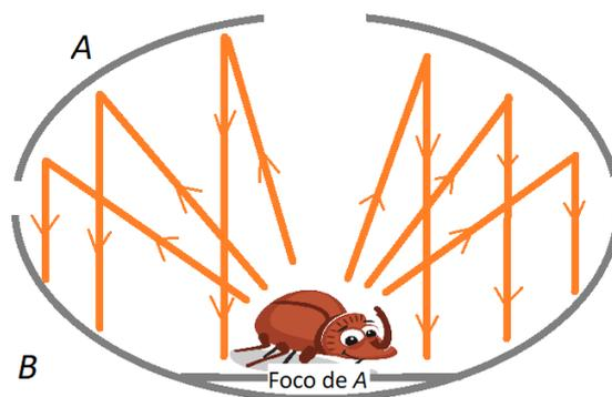
Por otra parte, el foco del espejo parabólico *B* se encuentra en el hueco situado en la parte superior del sistema, con lo que los rayos que incidan paralelos al eje del espejo *B* se reflejaran pasando por este foco. Dichos rayos de luz que inciden en el espejo *B* son los reflejados por el espejo *A*.
