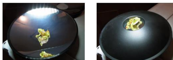
Figura 2: Doble espejo parabólico y formación de la imagen invertida.
